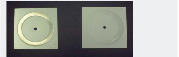
Tekutý nátěr PVDF vlevo a Interpon D3000 – Fluoromax vpravo. Test byl prováděn při stejné tloušťce nátěru.
